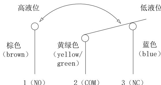
1. 黄绿色与棕色电线端子匹配: 高液位接通, 低液位断开。
