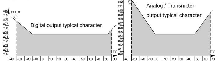
TTD6N 的精度与管壁材质、安装、环境温度、风速等相关, 难以达到上述精度。
