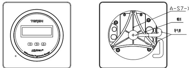
2 由于压差表都有侧面和背面二对压力接口, 并有+(HIGH)/-(LOW)端的差别, 在使用这些配件进行压力连接时, 要按实际需要正确连接, 并保证密封不使用的另一对压力接口。
