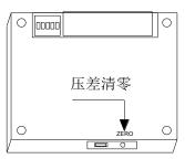
由于使用环境和传感器自身特性原因,长期使用后产品有可能漂移,导致精度降低。故本产品在安装后必须清零一次,否则 有可能无法达到标称精度。另建议持续使用7天后,再清零一次,以提高精度。此外,应在使用后定期(如6-12个月)或确认本产 品示值偏差超出允许范围时进行一次清零。
