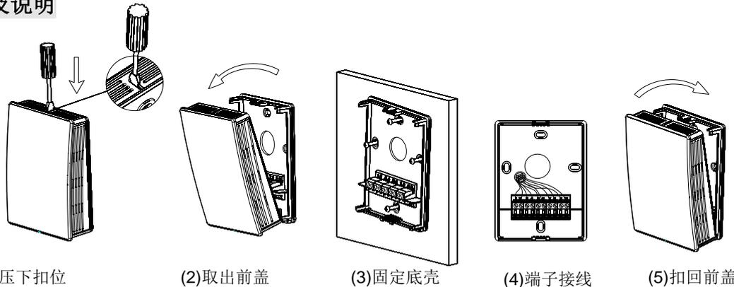
注：产品电子元器件全部安装在前盖内侧，应小心打开。底壳上仅有接线端子。
