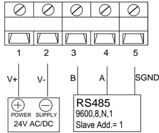
RS485/MODBUS 参照《IAQM 多功能空气质量探测器 MODBUS 通信说明书》。RS485 终端电阻拨码开关 J8 使用说明如下：RS485 终端电阻拨码开关拨到“ON”，终端电阻为 120Ω；拨动开关拨到“OFF”，无终端电阻。如下图：
