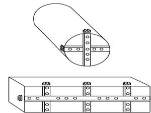
图 7 多个测片安装示意图
